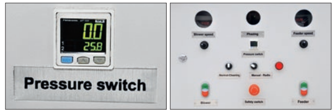
3 Wyłącznik ciśnieniowy programowalny - zapewnia równomierną powtarzalność gęstości materiału przy wdmuchiwaniu w przestrzenie zamknięte Pressure switch programmable - ensuring consistent reproducibility of the density of the material by blowing in closed spaces Programmierbarer Druckschalter - versichert die kohärente Reproduzierbarkeit der Dichte des Materials beim einblasen in die geschlossenen Räume
