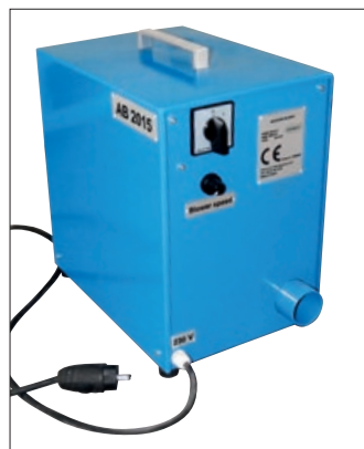
11 Dodatkowy zespół dmuchaw AB 2015 „wzmacniacz” z osobnym bocznym wyjściem do materiałów drzewnych i celulozowych, zasilanie 1-fazowe, moc nominalna 2800 W Additional set of blowers AB 2015 „amplifier” with a separate side entrance for wooden and cellulose materials, power 1-phase, nominal power 2800 W Zusätzlicher Set der Gebläse AB 2015 „Verstärker” mit einem separaten Seiteneingang für Holz- und Zellstoffen, Leistung 1-phasig, Nennleistung 2800 W
